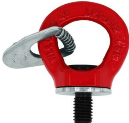
Powertex celšanas cilpa LPS. Izstrādāts prasīgai videi, kurā nepieciešama uzticamība un efektivitāte. Powertex LPS cilpām ir dinamiska 360 grādu rotācijas funkcija un iespaidīgs darba slodzes ierobežojuma (WLL) pieaugums par 4,5 reizēm salīdzinājumā ar parastajām DIN580 celšanas cilpām. Tās konstrukcijā ir iestrādāta izturīga kalta grozāmā cilpa, ko papildina skrūves un plāksnes komplekts, kas nodrošina drošas un daudzpusīgas celšanas darbības.
